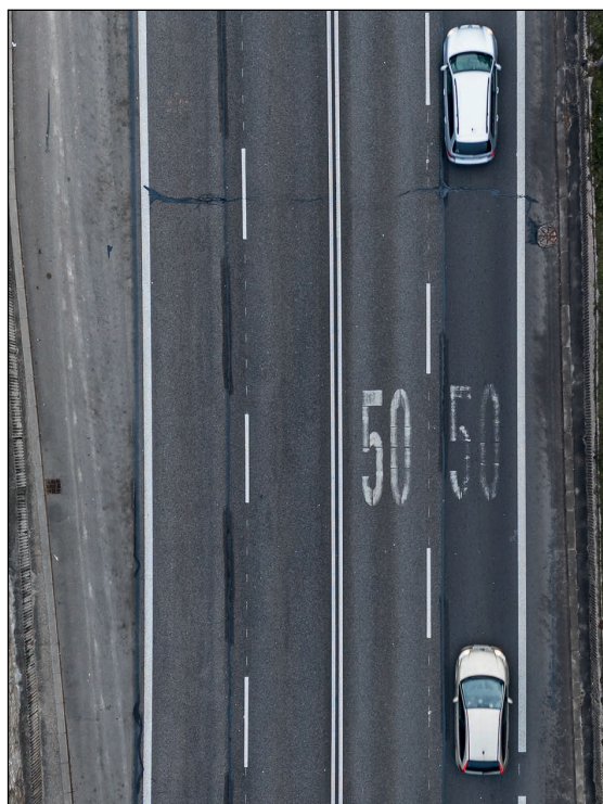
Obr. 25 ▲ Príklad vyznačenia dopravného značenia na vozovke, ktoré vodičom pripomína najvyššiu povolenú rýchlosť
