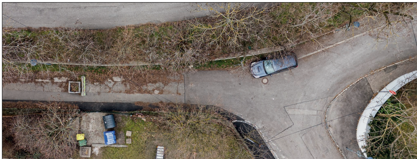
Obr. 18 ▲ Príklad zaslepenia ulice v Bratislave na Šulekovej ulici, ktorá bola dlhodobo využívaná vodičmi na skracovanie cesty. Cesta nemala dostatočné šírkové parametre a jej nadmerným užívaním sa výrazne znižovala kvalita života obyvateľov bývajúcich v tejto lokalite. Po dlhodobom nerešpektovaní dopravného značenia sa mestská časť rozhodla cestu zaslepiť kvetináčom, ktorý zároveň umožňuje prejazd cyklistov a peší pohyb.
