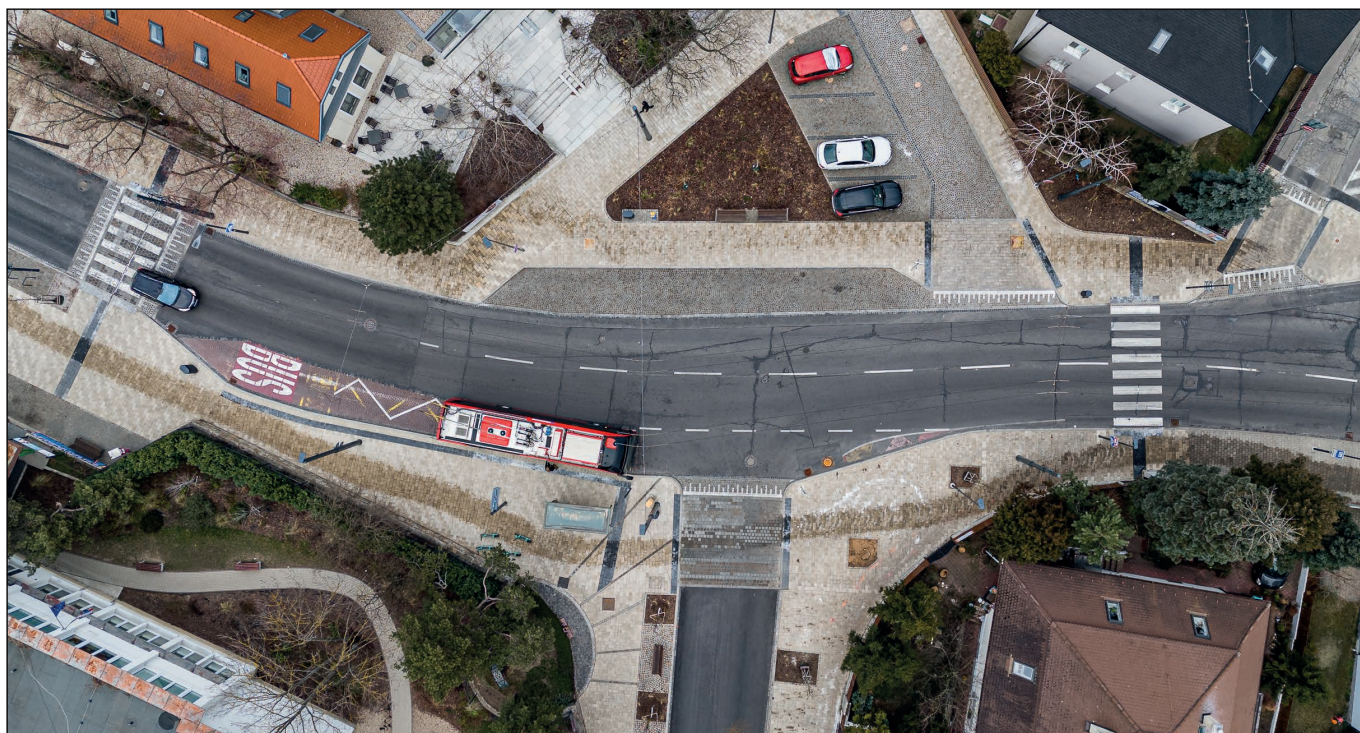
Obr. 23 ▲ Príklad zmenšovania polomerov nároží križovatiek spolu s uplatnením priebežných chodníkov a vyvýšeného priechodu
