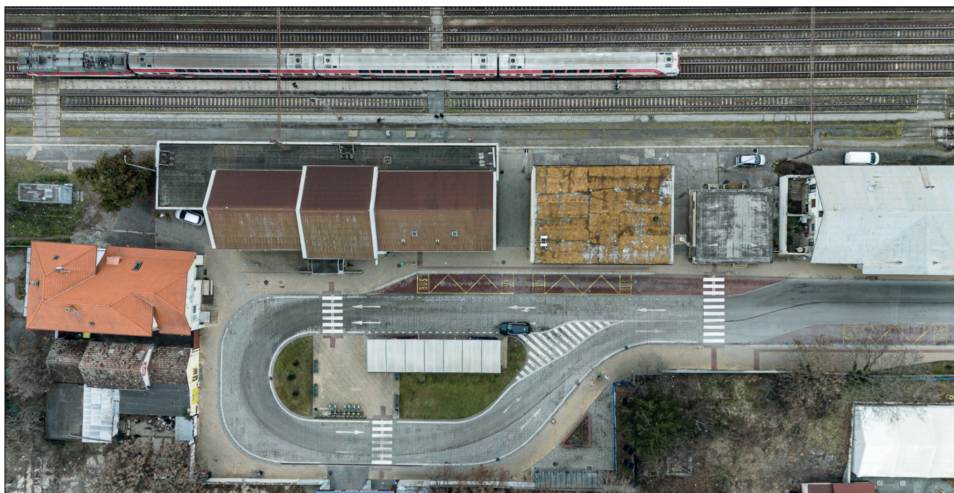
Obr. 28 ▲ Príklad integrácie verejnej osobnej dopravy zo Senca. Na zábere vidieť nástupište železničnej dopravy, ktoré je úrovňovo prepojené s nástupišťom regionálnej autobusovej dopravy, prostriedkami dopravy poslednej míle (t.jt. pohyb tovaru z dopravného uzla do konečného miesta určenia) a krátkodobým státím Kiss & Ride
