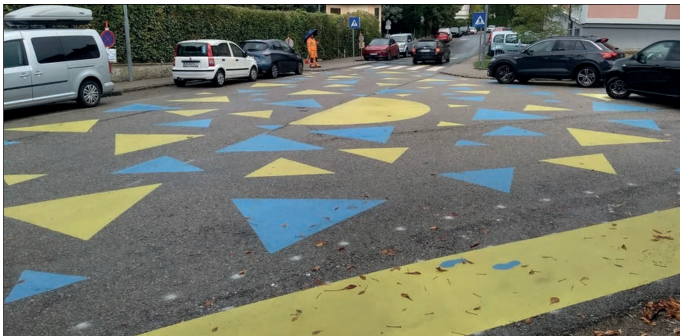
Obr. 27 ▲ Príklad dopravného upokojuvania vyznačením geometrických tvarov v križovatke formou vodorovného dopravného značenia v obci Perchtoldsdorf v Rakúsku (zdroj: https://www.cvp.at/perchtoldsdorf-wird-bunt )
