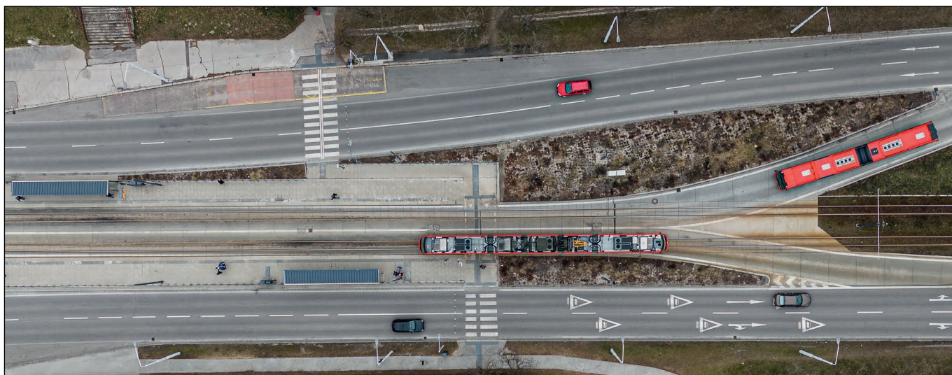
Obr. 5 ▲ Zastávka Záluhy v Bratislave je príkladom dobrej praxe prestupu medzi autobusmi a električkami na jednej nástupnej hrane. Hoci má zastávka podchody, je riešená aj bezbariérovo.
