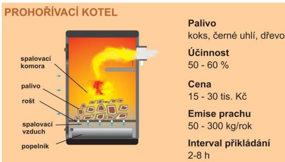
Obr. 1 Funkční schéma prohořivacího kotle
