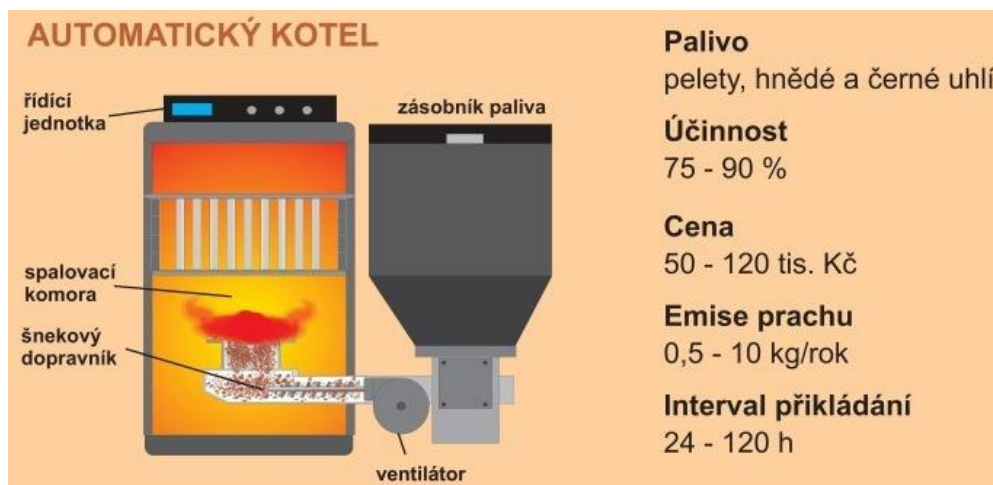
Obr. 4 Funkční schéma automatického kotle
