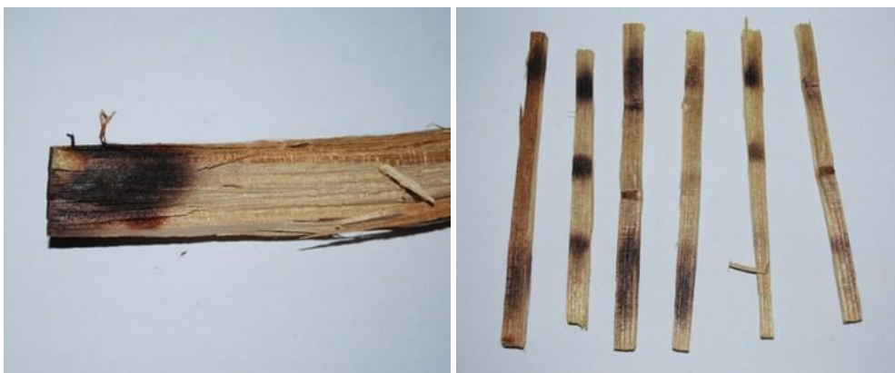
Obr. 11 Vzorky třísek, které byly sušeny zbytečně dlouho – vzorek dřeva sušte tak, abyste tohoto vzhledu nikdy nedosáhli.
