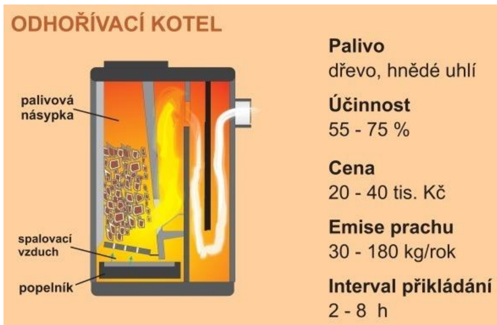
Obr. 2 Funkční schéma odhořivacího kotle
