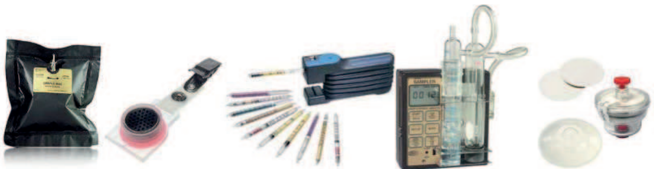
Vzorkovací vak, pasívny a aktívny vzorkovač s tuhým sorbentom, impinger a filtre
