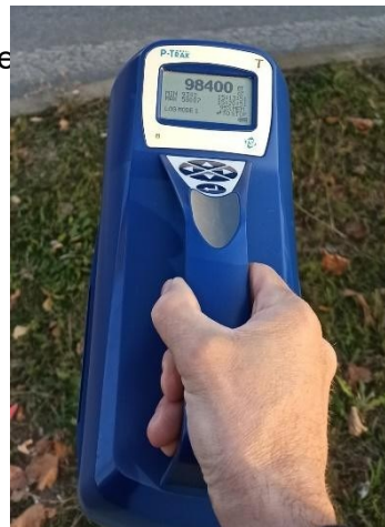
Obr. 1: Prenosný merací prístroj P-Trak, model 8525.
